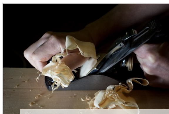
Calibratura dello spessore della tavola armonica
